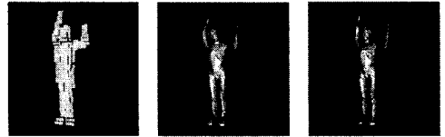
(a) ボクセルデータ (b) 可動領域干渉を考慮しない推定結果 (c) 可動領域干渉を考慮した姿勢推定
