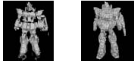
図2：(左)複数距離画像の合成による形状データ (右)視体積交差法による形状データ
